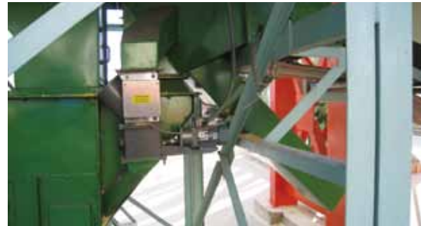
智能烘干： 通辽直属库应用 DM510 出机传感器，采用了最先进的在线水份测量及控制技术，实时调整到最佳的排粮速度
