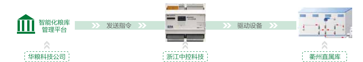
智能气调： 衢州直属库应用工业级控制设备进行改造，采用光纤通讯系统，在第一代智能气调的基础上获得实时参数，完备气调功能
